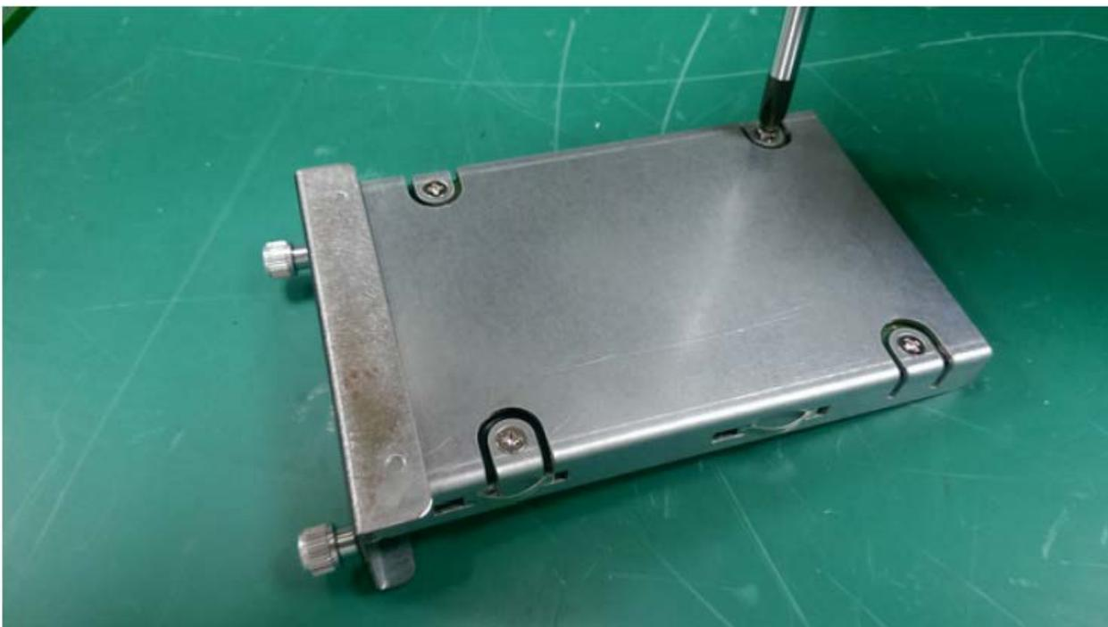
4. Установите лоток в слот компьютера и закрутите винты.
