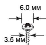
**ПРИМЕЧАНИЕ:** Перед ввинчиванием болтов убедитесь, что диаметр головок и стержней болтов подходят к отверстиям крепежного устройства.
