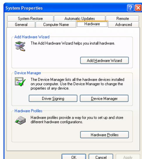
Выберите вкладку **Hardware [Устройства]** и нажмите на кнопку **Device Manager [Диспетчер устройств]**. При помощи мыши поместите курсор над подпунктом CP-168 Series в пункте Multi-port serial adapters и нажмите на ней правую кнопку. В появившемся списке выберите пункт **Uninstall [Удалить]**.
